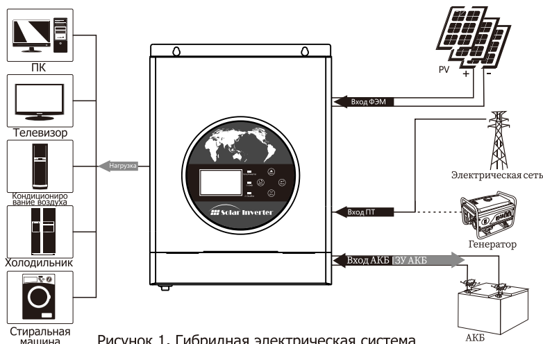
Рисунок 1. Гибридная электрическая система
